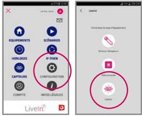
**1-** Dans l'application LiveIn2, depuis le menu CONFIGURATION, ajouter l'équipement BHz « capteur ». Se laisser guider par l'application pour appairer le capteur avec son bouton PROG.
